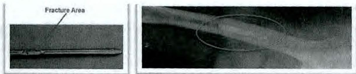
Рис. 2: Область риска скола/отколовшийся фрагмент на рентгенограмме.
